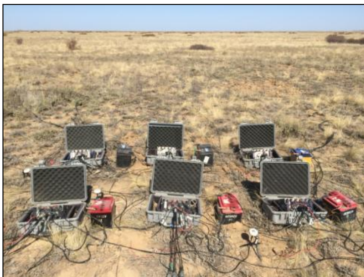
5.5-сурет – Тіркеушілерді "Box Calibration" режимінде калибрлеу
